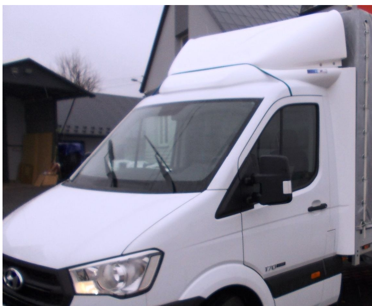
Nr. 1 Spoiler Hyundai H350 höhenverstellbar geklebt
