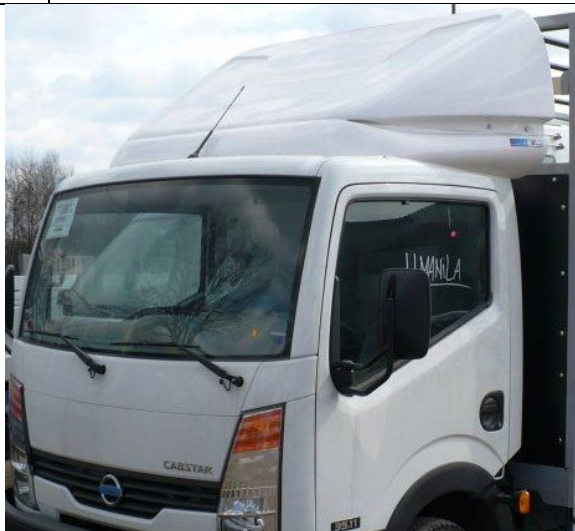
Nr. 1 Spoiler HV geklebt
