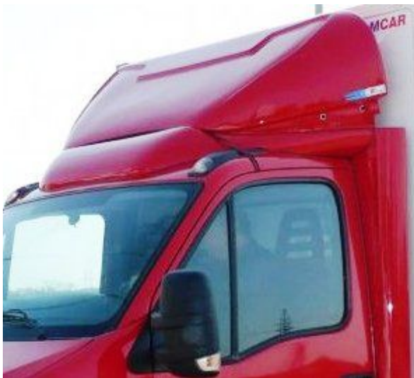
Nr. 7 Spoiler höhenverstellbar geklebt
