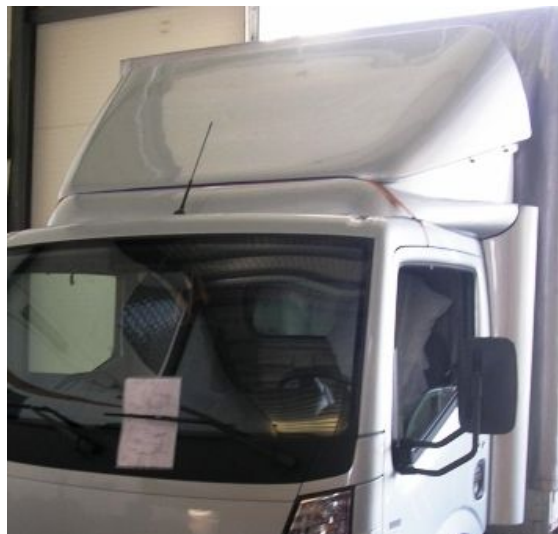
Nr. 9 Spoiler Maxity HV geklebt
