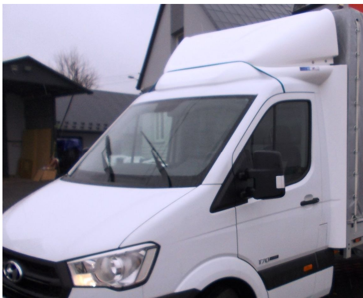
Nr. 1 Spoiler Hyundai H350 höhenverstellbar geklebt
