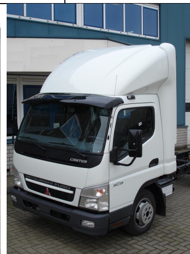
Nr. 5 Spoiler fix geklebt
