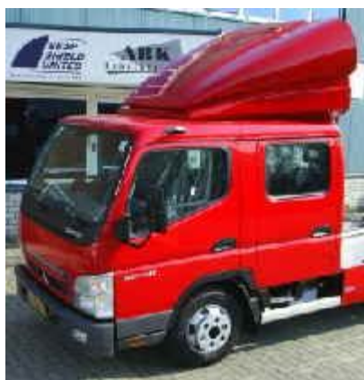
Nr. 6 Spoiler Doppelkabine HV geklebt
