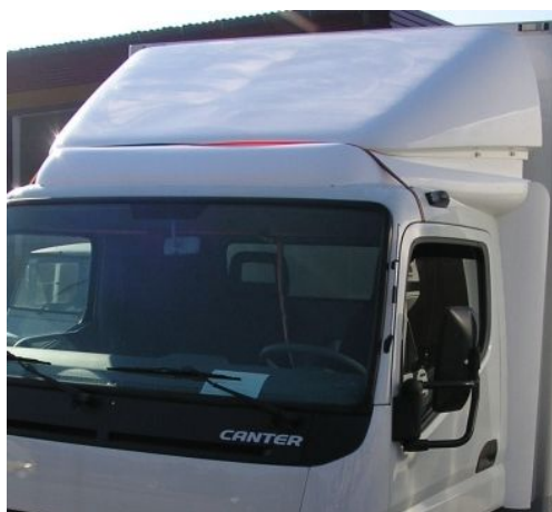
Nr. 4 Spoiler HV geklebt
